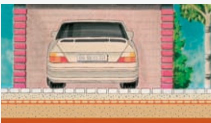
Indkørsel med armeringsnet
